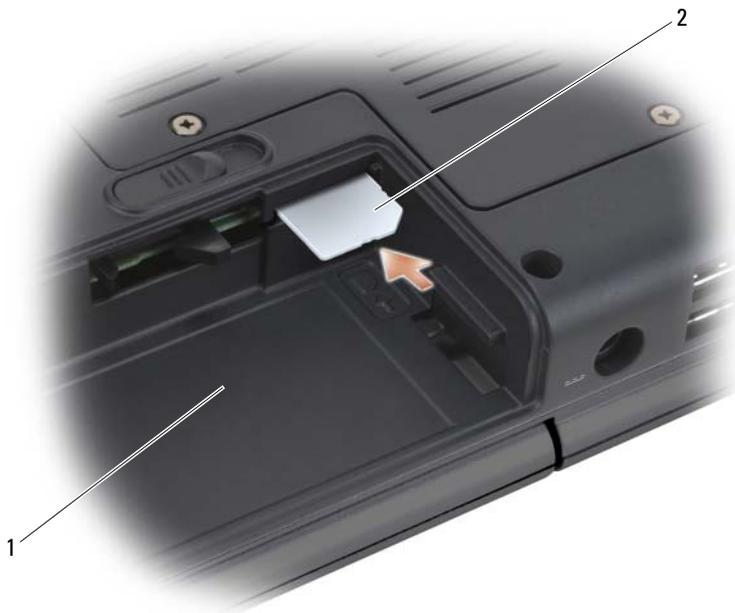
1 alloggiamento della batteria    2    SIM
