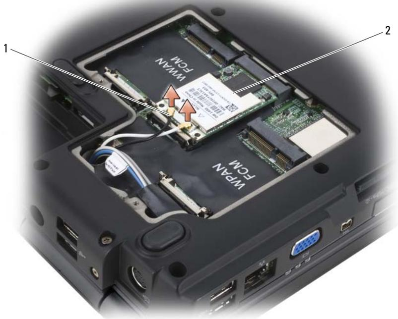
1 connettori del cavo dell'antenna (2) scheda WLAN
